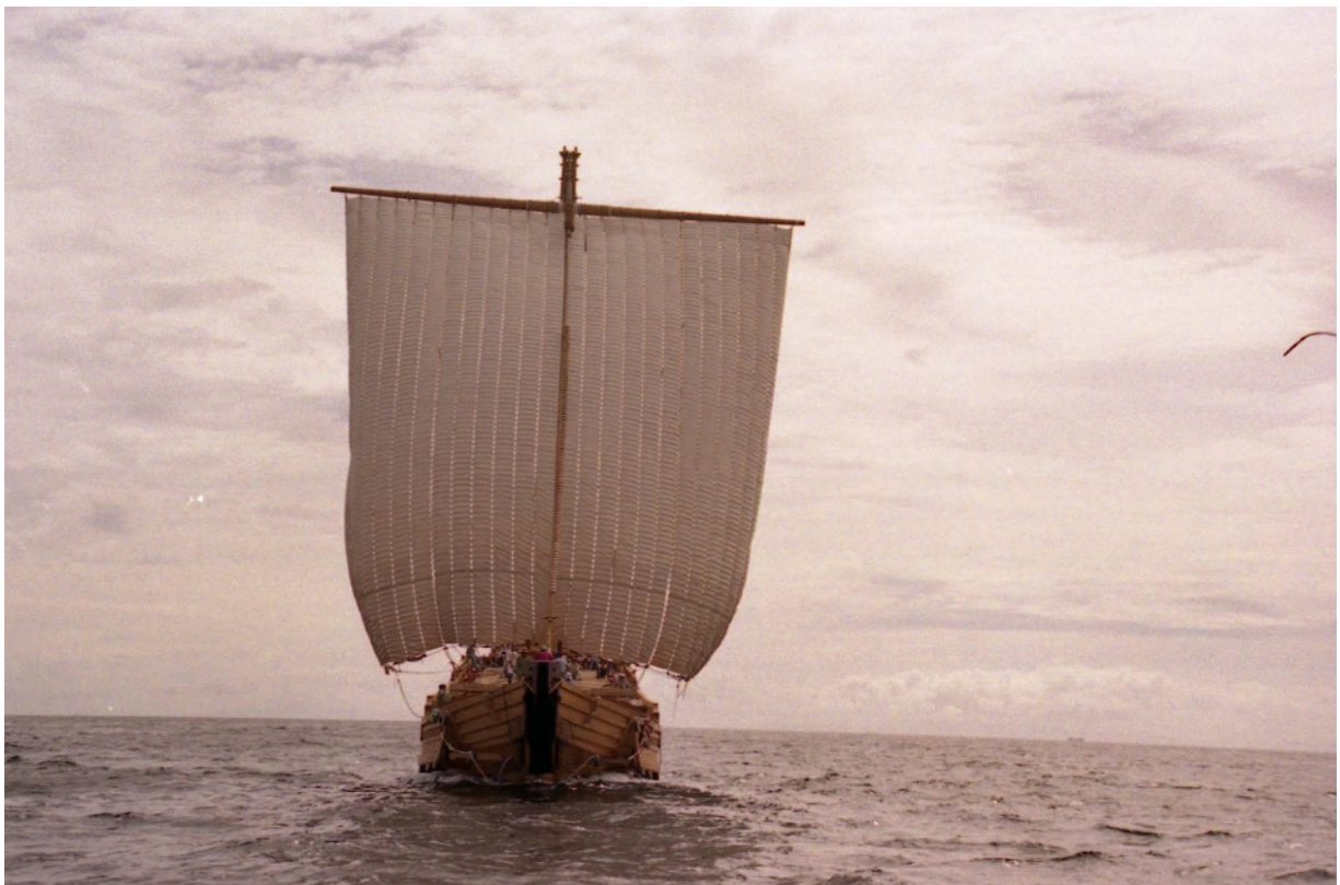
図6 (下) 真追手の帆走、風速 7m 毎秒、帆の両下隅にはそれぞれ2本のテークルが付いていて、それぞれ一本は船尾端へ、もう一本はゆるく船首へ、帆の下縁の多数の帆足は帆柱の後ろの大渡しに引き付けてある
