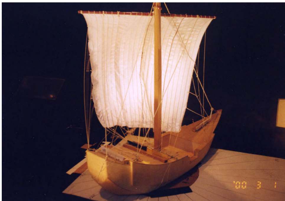
図 1 5 図 1 4 と同じ詰開き——タックの代わりに脇取り綱と帆足で張り合わせるが帆の下の方が遊びがちで、その分性能が落ちる
