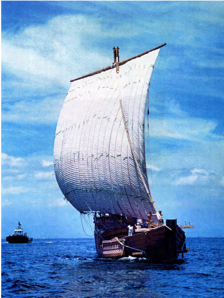
図5 (左) 左舷詰め開き帆走、風速 4m 毎秒、帆の船尾側下隅に付くテークルの一本はシートになって右舷船尾へ引かれ、もう一本は舷外に垂れて右舷船首へ延びている
