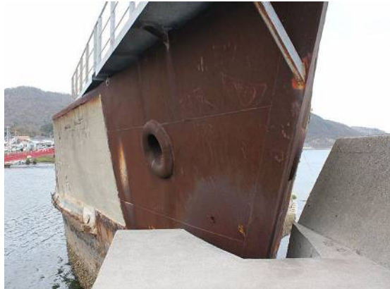
第二武智丸：左図は船尾から船首を見る、右図は鉄板で補強された船首
