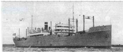
(FIG-2) 1 万 DWT 型標準軍艦油槽船
