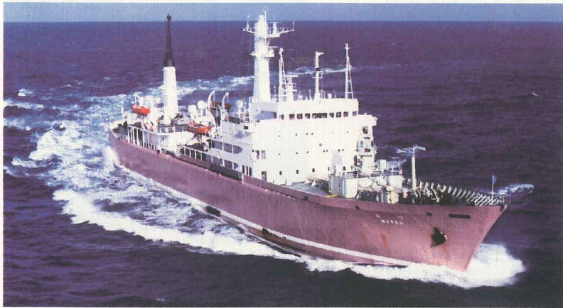
▲原子動力により太平洋を航行中の原子力船「むつ」（1991年12月） 全航海で約8万2,000kmを航行、「むつ」原子炉は100%出力換算で約2,250時間運転
