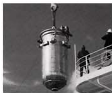
原子炉容器の搭載：45年7月、 原子炉の艗装工事に着手し、 翌年2月には原子炉容器が搭載さ れました
