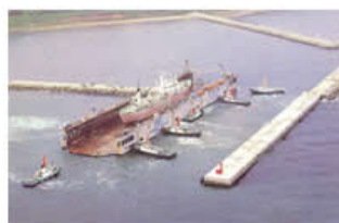
船体点検のため浮ドックに上架され 関根浜港内へ曳船される「むつ」
