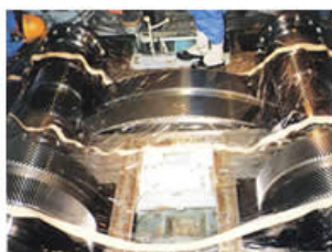
主機減速装置の解放点検
