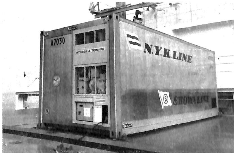
ハッチカバー上の内蔵型冷凍コンテナ
