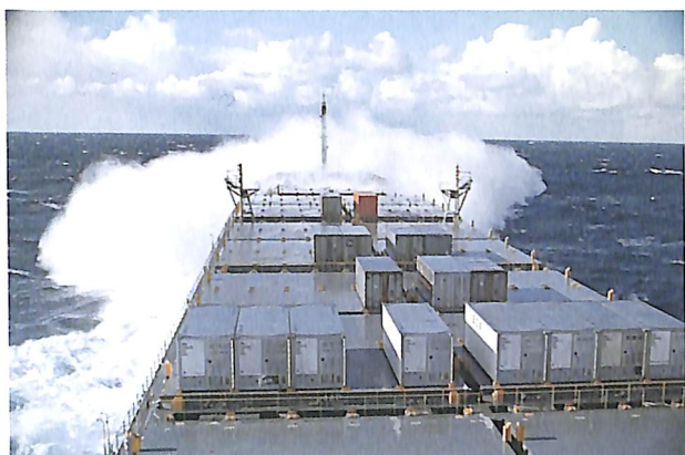
SR125 実船実験の写真（鎌倉丸に計測コ ンテナを積み込んで総合的な耐航 性実船試験を行った。北大西洋に 於いて荒天に遭遇した時の写真）
