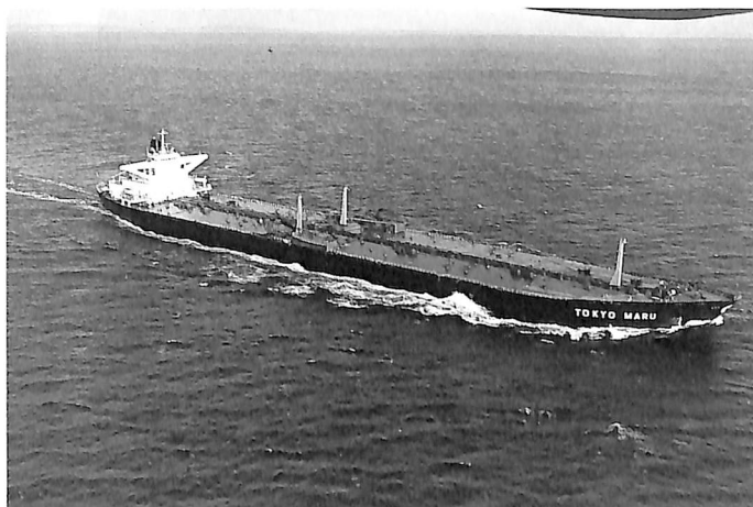
▶ SR99 東京丸 航海中の船体応力頻度に関する 実船試験の供試船
