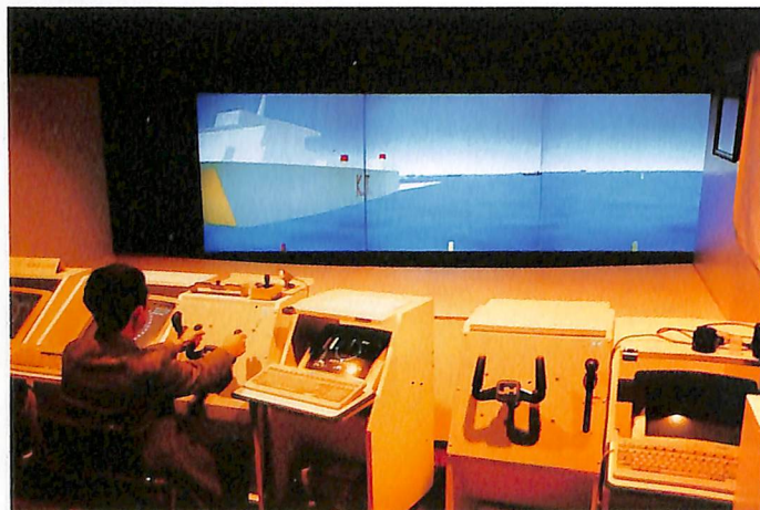
◀ RR 744 操船シミュレーターによる高速船運航の安全評価
