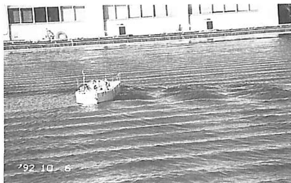
SR216 大型船縦通肋骨材の強度に関する研究 VLCC 短波長域での変動水圧測定
