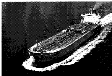
S5362 L×B×D：180.00×32.20×19.30 D/W：46,900t 船主：株式会社富洋海運 殿 船種：METHANOL TANKER
