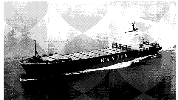
2,553個積コンテナ船 L×B×D：199.90 m×32.20 m×16.60 m 総トン数：27,200トン
