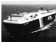
船種：日航高速船 積載台数：3,900 台 L×B×D：190.00×28.20×31.25m
