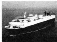
船種：RO/RO船 総トン数：11,400 t L×B×D：169.95×26.00×24.60m
