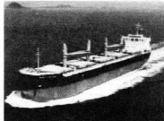
船種：バルクキャリア D/W：58,000 t L×B×D：189.90×32.26×18.40m
