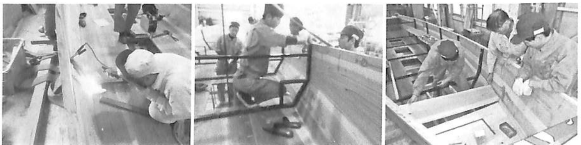
写真10 船首ステップの取付 写真11 ポリカ板の穴開け 写真12 ポリカ板の取り付け
