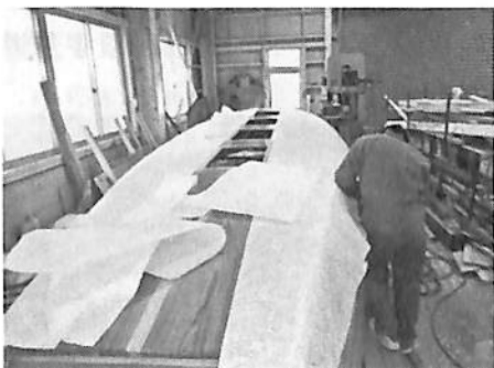
写真1 ガラス繊維積層
