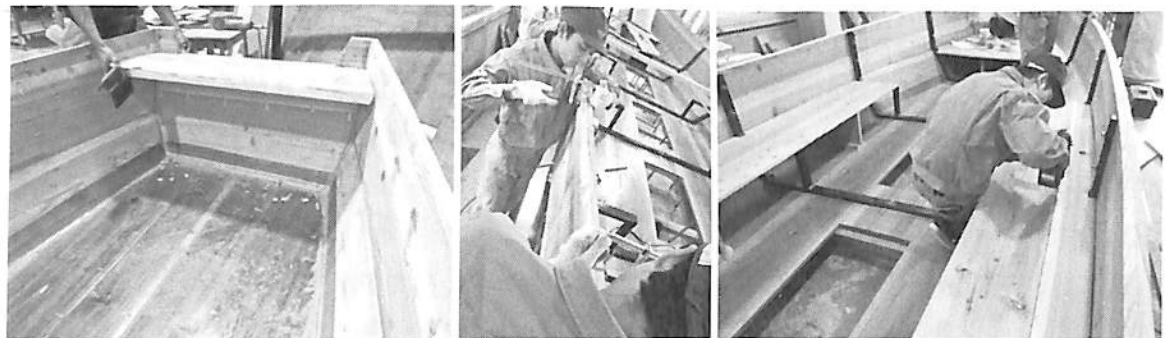
写真7 船尾デッキの取付 写真8 コベリ取付 写真9 座席の取り付け
