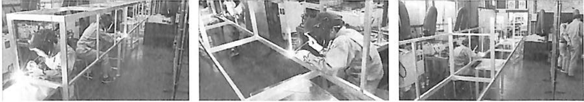
図10 組み立ての様子 (TIG 溶接)
