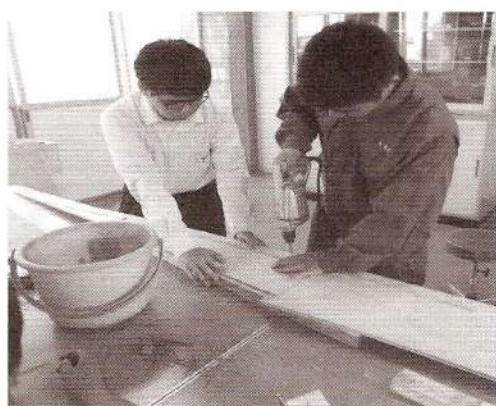
(船底にステッチのための穴あけ)
