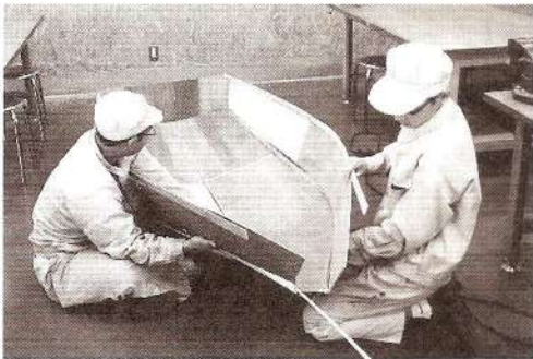
写真3 船体外板の縫い合わせ
