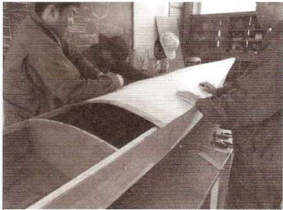
(デッキ貼り付け作業)
