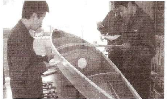
(接着剤塗布作業)
