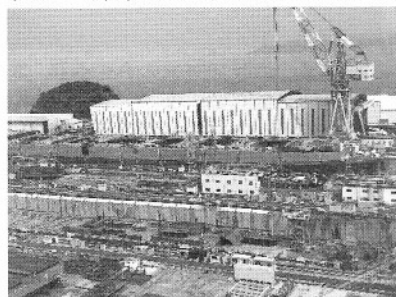
写真：ブロック建造
