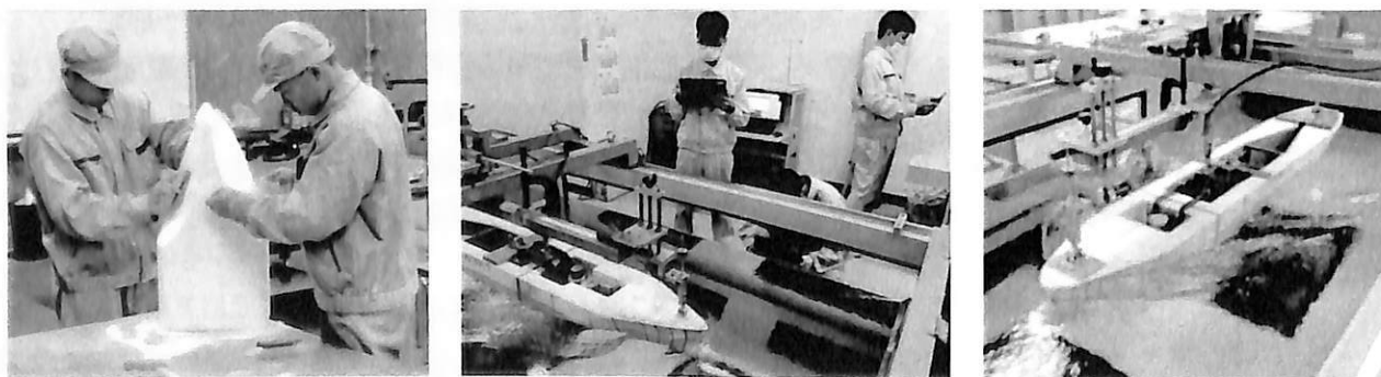
図7 船首模型の製作(左)と回流水槽による抵抗試験の様子
